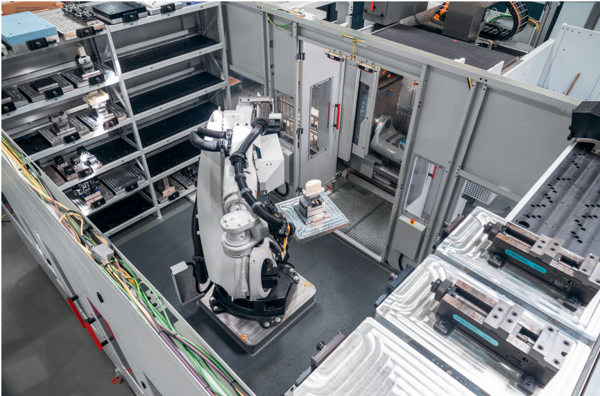
Der Roboter RS 2 entnimmt eine Palette mit einem fertig bearbeiteten Kunststoffteil aus dem 5-Achs-Bearbeitungszentrum. © Hermle/faigle
